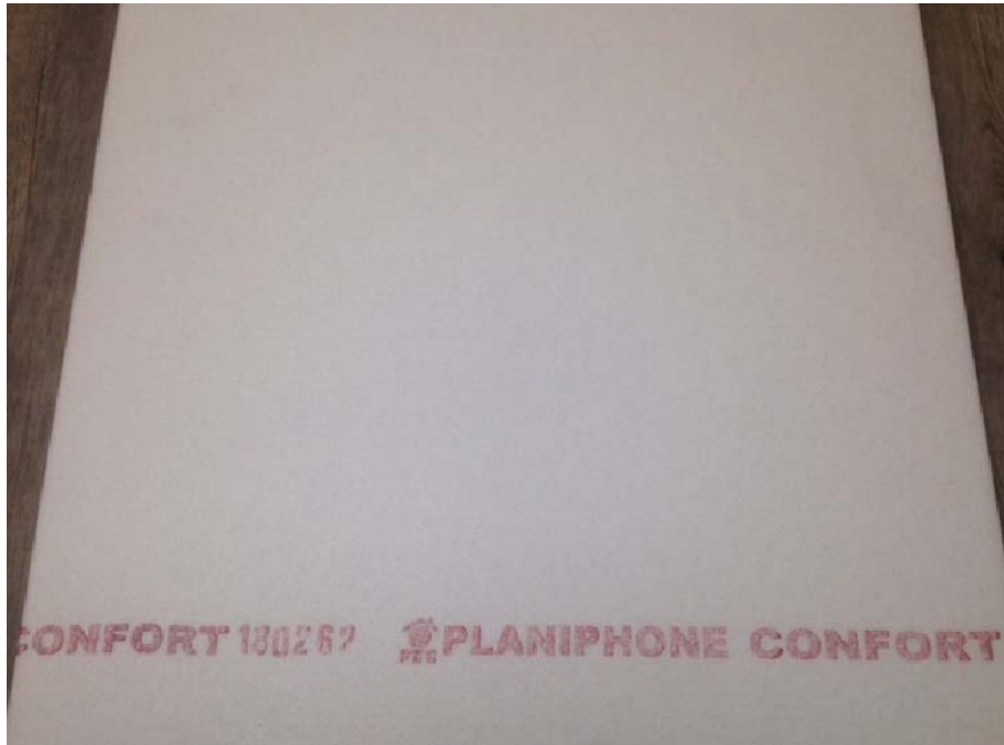
Figure 1 – Exemple de marquage de la sous-couche
